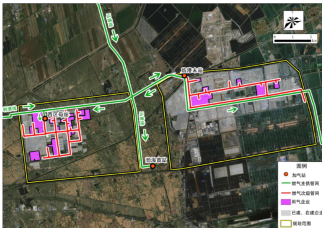
图 2.8.2-1 临港开发区供气管网图
