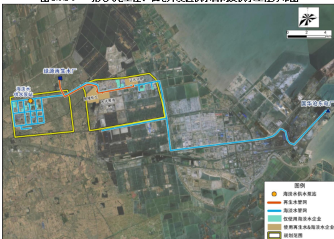
图 2.8.2-4 绿源再生水厂及中水管网、国华沧东电厂及海淡水管网分布图
