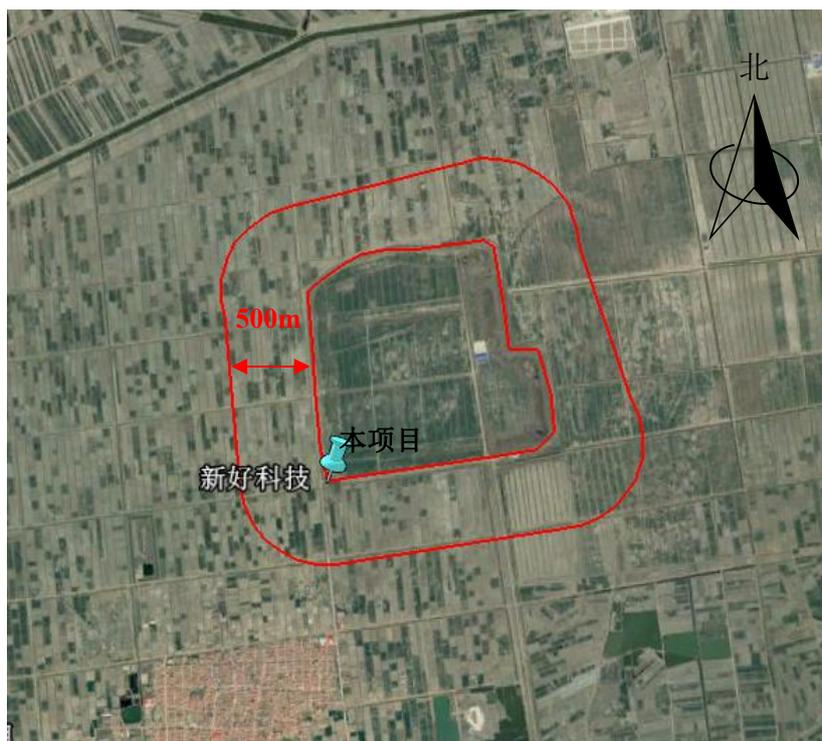
图 5.2.1-4 卫生防护距离包络线图
