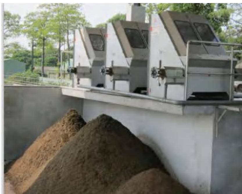
图 3.6-3 固液分离器示意图
