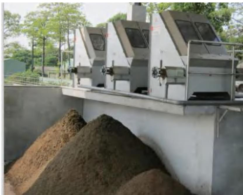
图 3.6-3 固液分离器示意图
