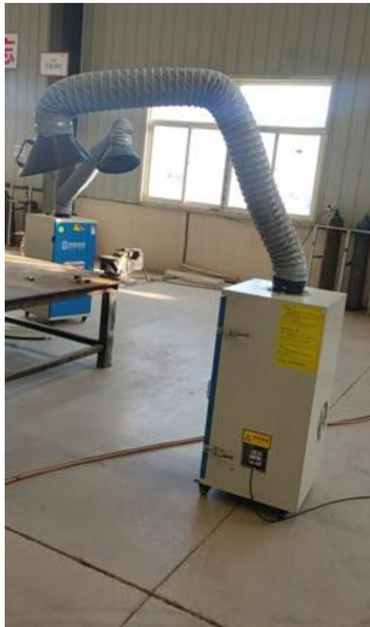
图 4-1 移动式焊烟净化器
