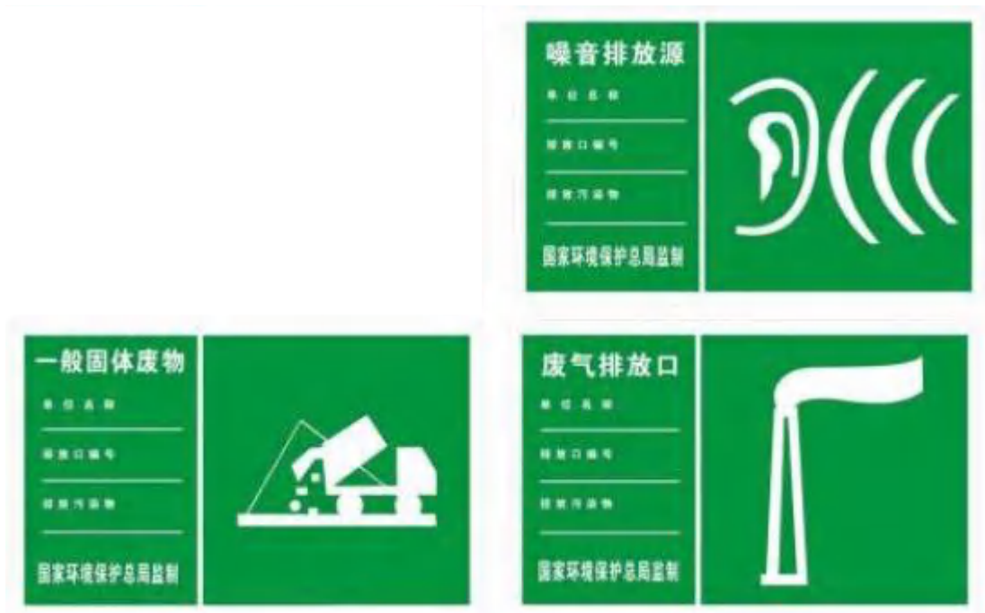
图 10.4.2-1 噪声、一般固废、废气排放源标志图
