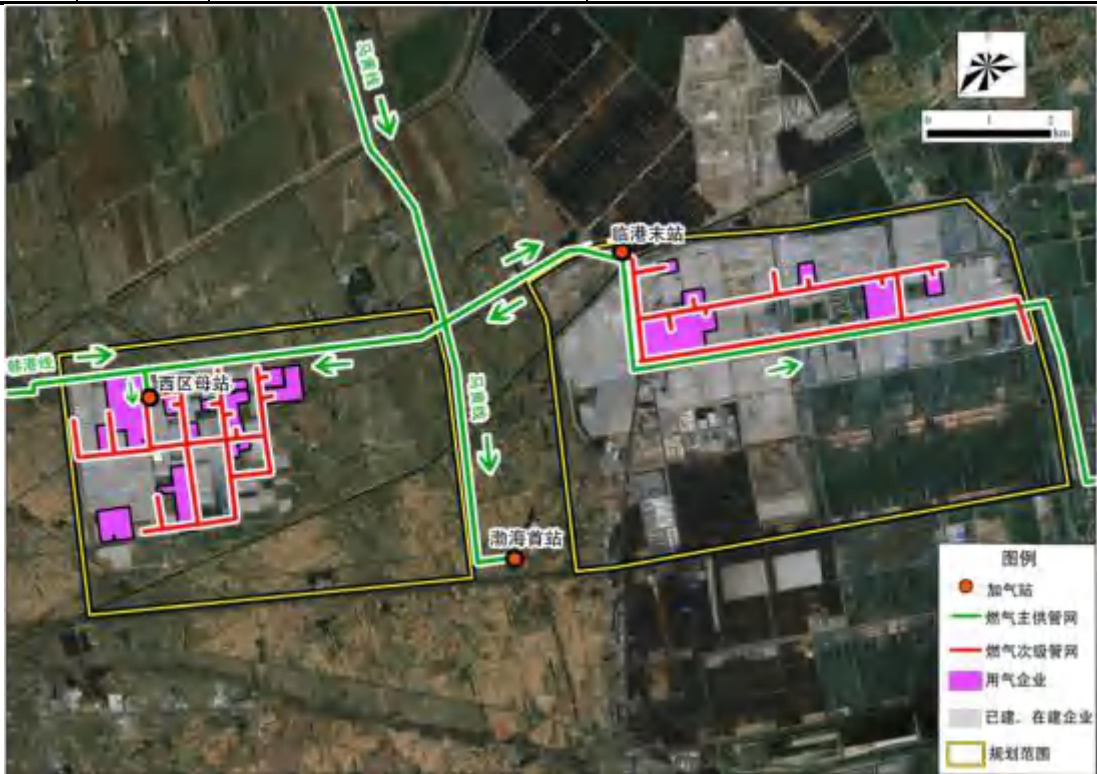
图 2.8.2-1 临港开发区供气管网图
