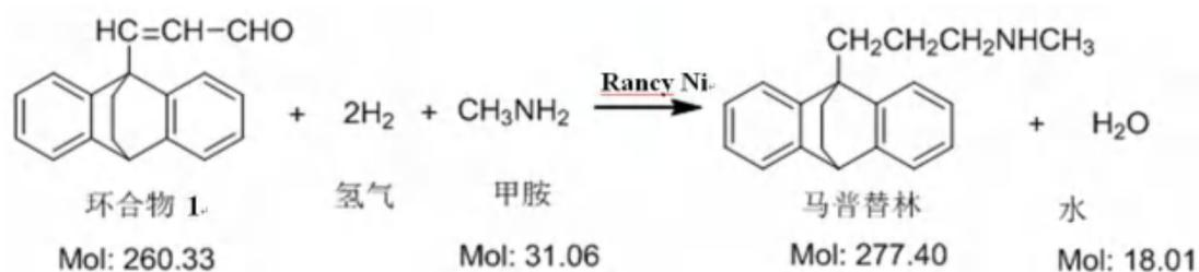
在高压反应釜中通过水冲泵真空吸入 56.25kg 甲胺醇溶液，步骤 2 所述制备的 Raney Ni 一批全量，密封加料口，通过高压反应釜内伸长管向釜内通氢气，
