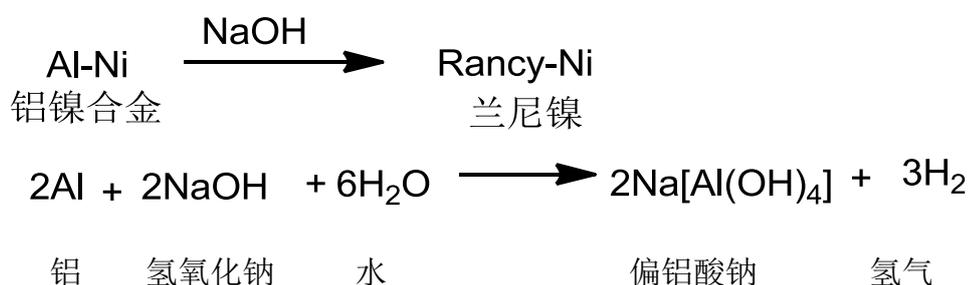
**(1) 反应:**（用氢氧化钠反应掉镍铝合金中的铝，以得到兰尼镍催化剂）在反应釜中加入新鲜水 304kg，搅拌下，人工加入氢氧化钠 30.4kg（此过程产生少量投料废气 G3-11：氢氧化钠颗粒物），反应釜夹层通蒸汽缓慢加热使罐内温度至 90~95℃，该温度下，人工缓慢加入镍铝合金 24.3kg（镍含量 47.27%），加毕，保持罐内温度为 90~95℃，搅拌反应 4 小时（此过程产生反应废气 G3-12: 氢气）。
