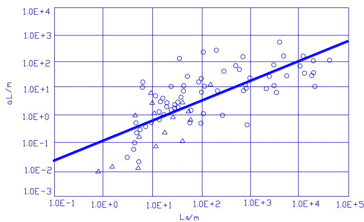
图 6.2.3-20 孔隙介质 2 维数值模型的  $\lg \alpha_z - \lg L_s$  图
