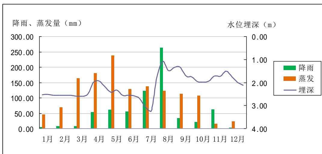
图 6.2.3-12 2016 年海卤区水位埋深与降雨、蒸发对比曲线图
