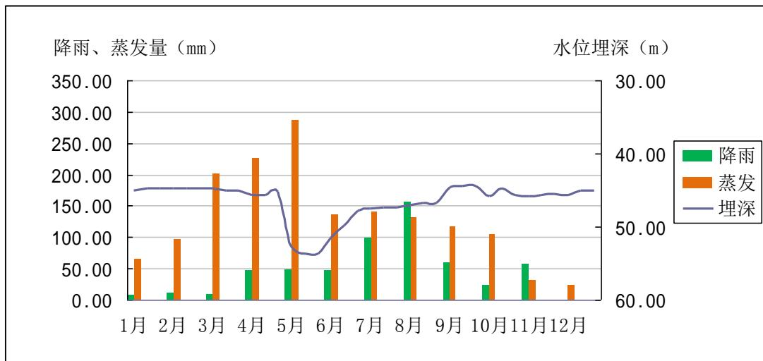
图 6.2.3-13 2016 年黄 37-3 水位埋深与降雨、蒸发对比曲线图
