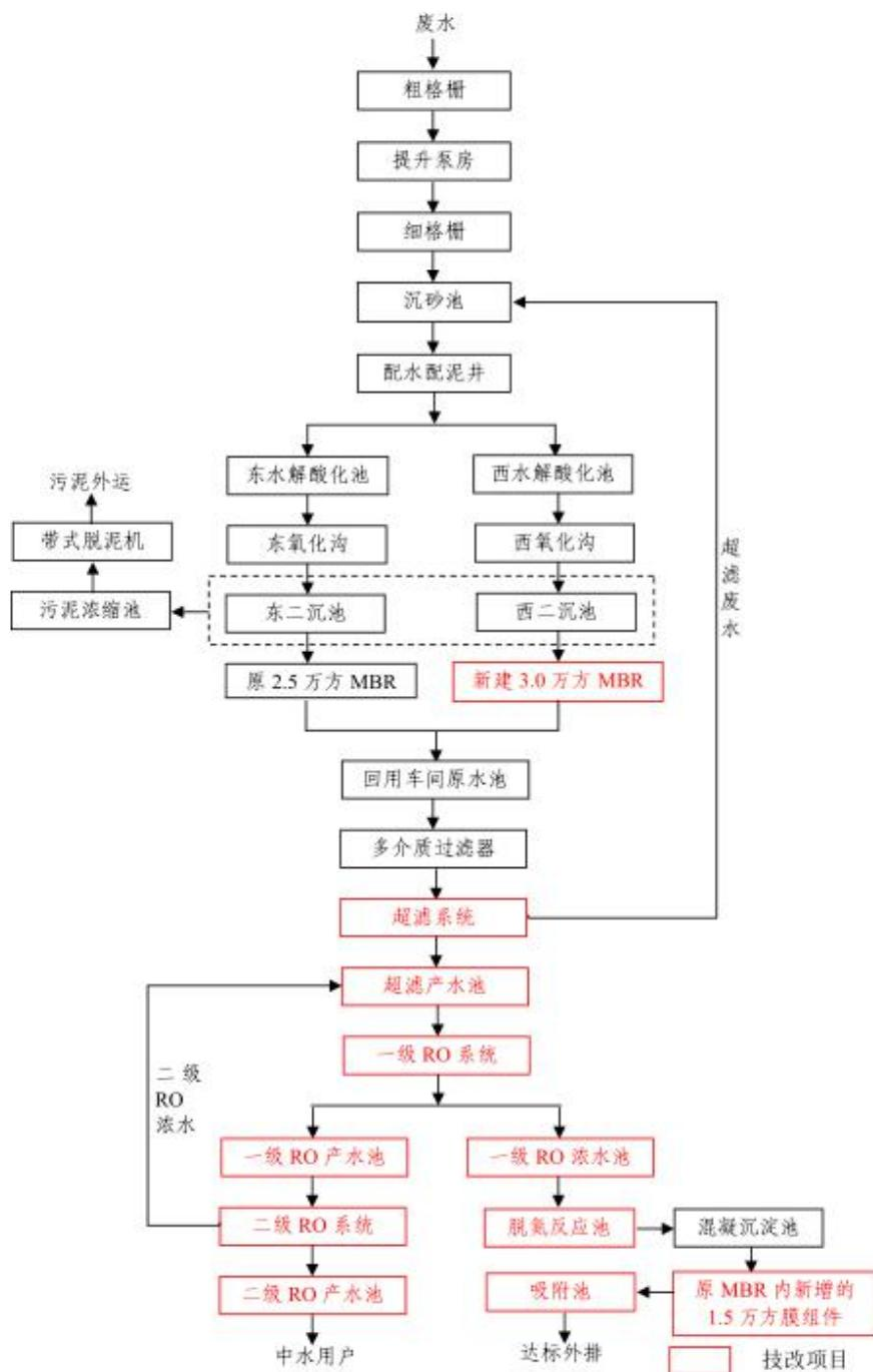
图 6.2.2-1 污水处理工艺流程图
