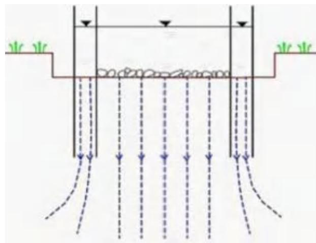
图 6.2.3-15 双环渗水试验原理图
