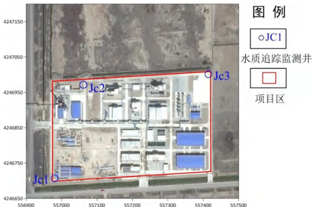
图6.2.2-24 浅层地下水水质追踪监测井布置图
