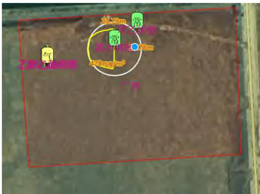
图 6.5.7-2 氨水泄漏下风向距离浓度曲线图
