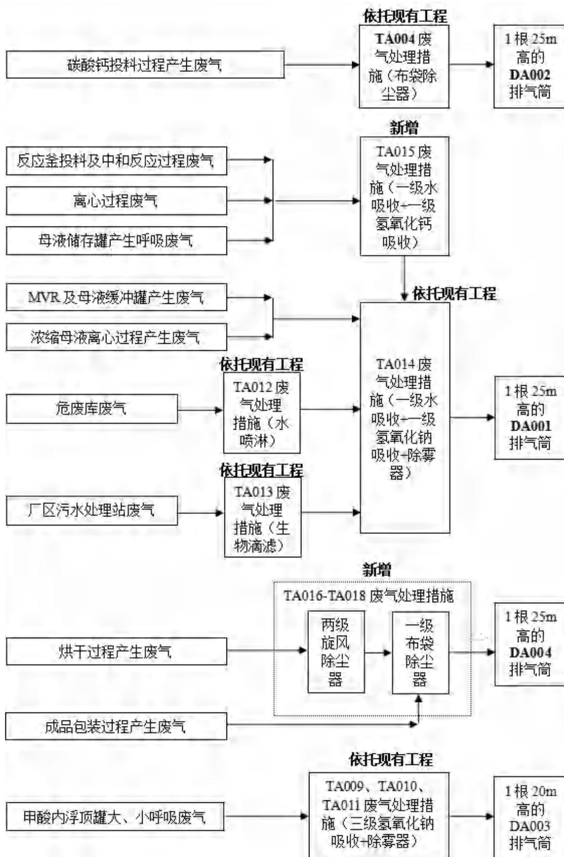
图 8.1-1 项目废气收集措施示意图
