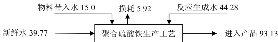
图 3.2.7.2-3 聚合硫酸铁水平衡图 单位：m 3 /d
