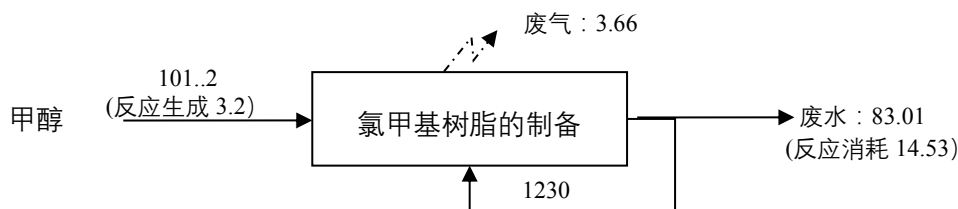
图 3.6.3-4 氯甲基树脂甲醇溶剂平衡图 单位：kg/批
