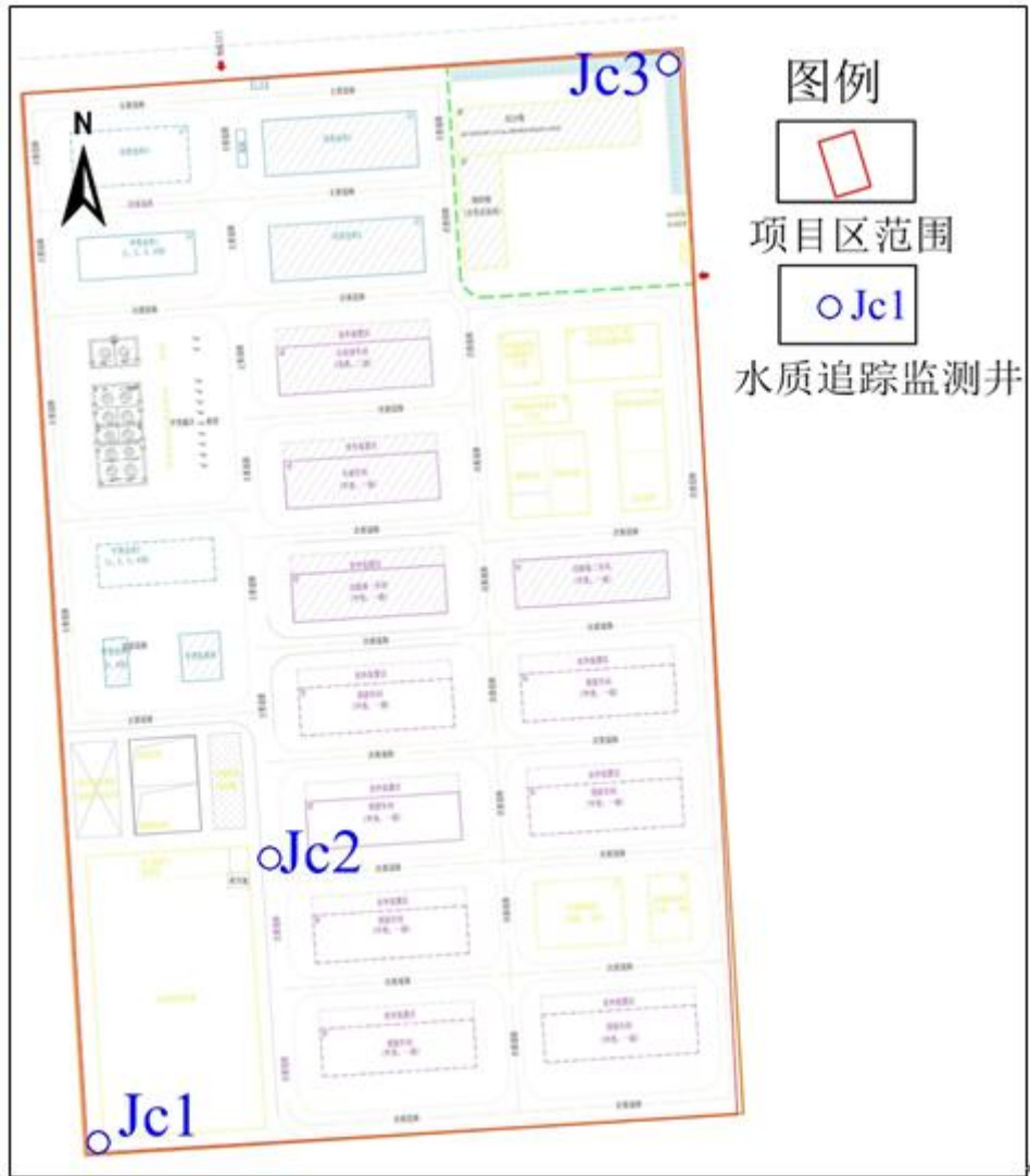
图5.2.3-26 浅层地下水水质追踪监测井布置图
