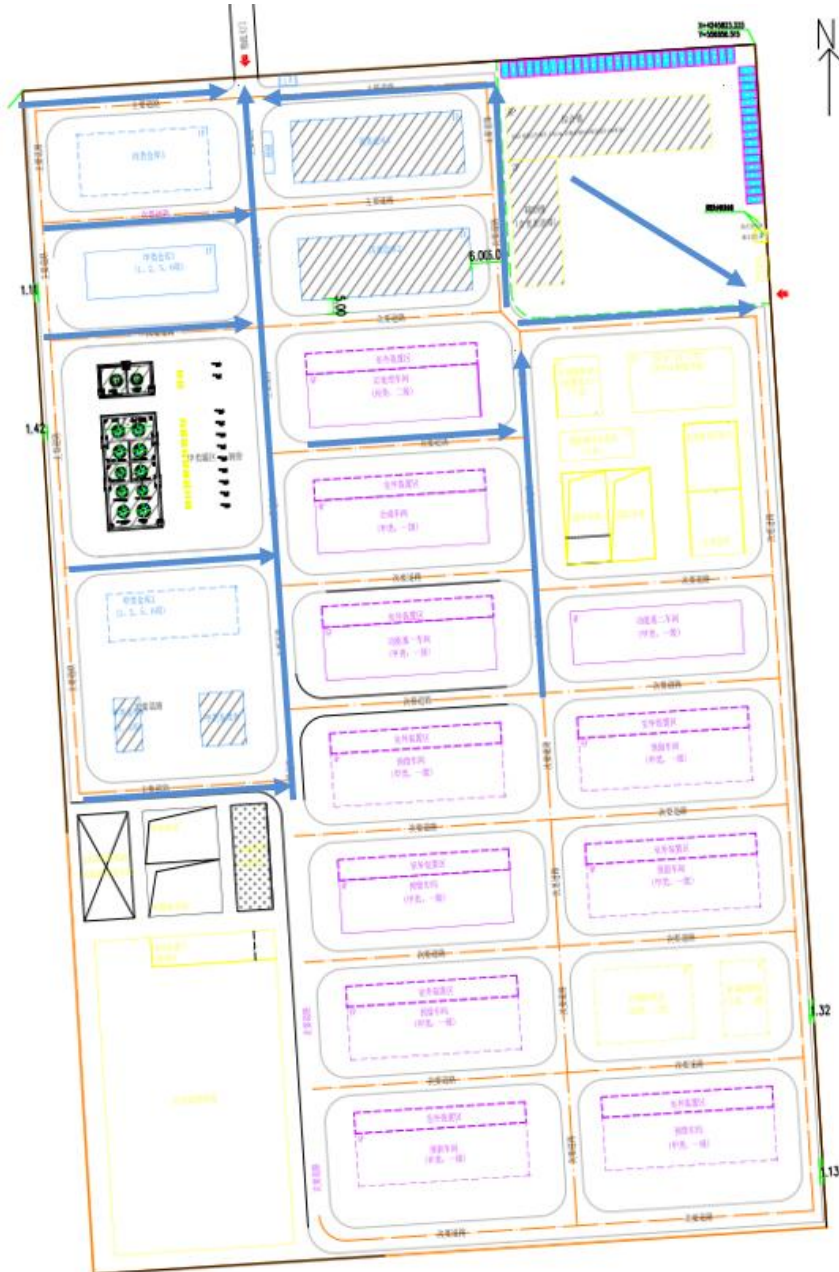
图 6.7-1 厂区应急疏散通道、安置场所位置图
