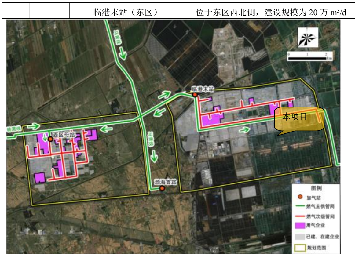
图 2.8.2-1 临港开发区供气管网图
