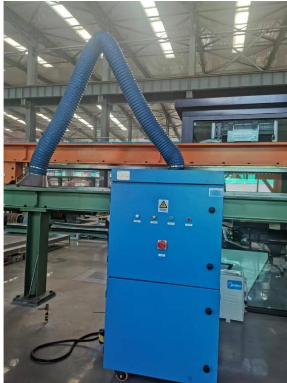
图 4.2.2-5 移动式焊烟滤筒净化器
